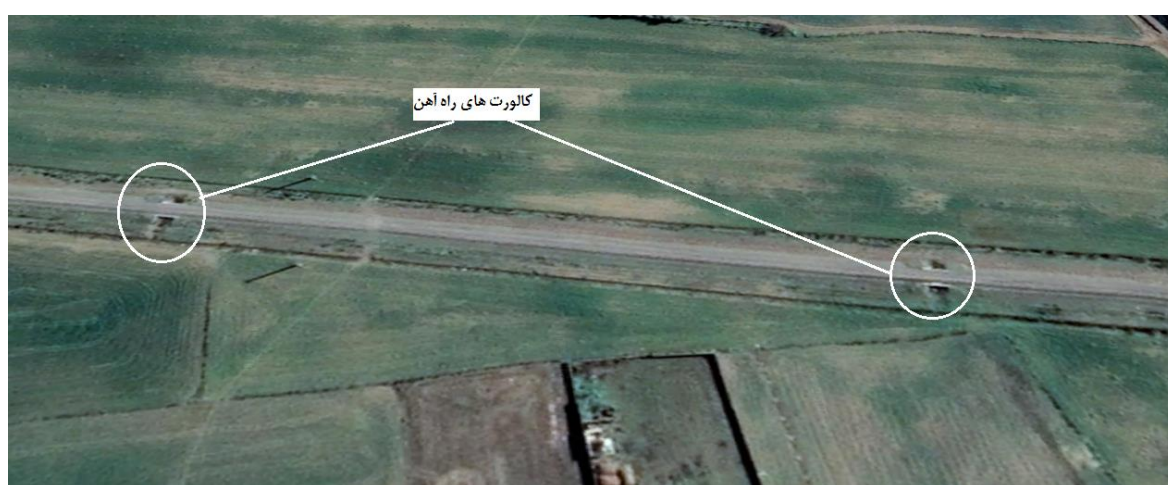
شکل ۲۴- نمونه ای از کالورت ها که بوضوح از روی تصاویر google earth نیز قابل مشاهده است
